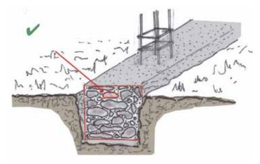
Los cimientos o pilares deben ser suficientes para el anclaje firme de las edificaciones livianas al suelo. Si su vinculación no es la adecuada, las fuerzas del viento puede arrancar la estructura de madera de los cimientos.
