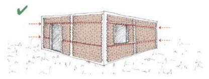
Donde sea posible, crear un sistema de refuerzo horizontal para fijar la base del muro al cimiento y las partes superiores de las paredes a los pisos de arriba o a techos de concreto. Esto genera una estructura rígida continua y conectada, y probablemente es la medida más importante en las edificaciones de albañilería.
