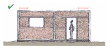
Deben colocarse bandas sísmicas a nivel del dintel, aun cuando no haya ventanas o puertas.
