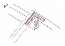
Hay que asegurarse de que el material que cubre la estructura del techo esté fijado de manera suficiente para resistir adecuadamente los vientos fuertes. Las chapas galvanizadas deben fijarse con tornillos para techo o clavos de cabeza grande. Deben superponerse en dos ondulaciones completas.
