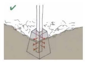
Los anclajes en forma de J que se introducen en el concreto de los zócalos conectan la franja del cimiento a la estructura de madera.
