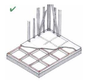
Hacer muros fuertes con maderas verticales y horizontales y un arriostramiento suficiente para resistir las fuerzas horizontales de los vientos fuertes.
