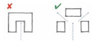
La fachada menor de una edificación debe enfrentar la dirección dominante de los vientos fuertes, para reducir la presión eólica sobre la construcción.
