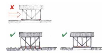
El poste de madera debe estar embebido en la plataforma de concreto. Los clavos crean una mejor conexión entre la madera y el concreto circundante.
