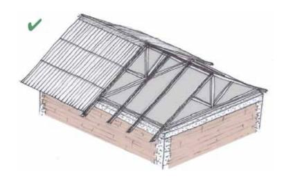
Usar techos de concreto sólo cuando los muros sean los suficientemente fuertes como para soportar este material.
