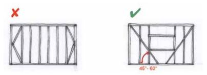
Comprobar que las maderas estén firmemente ensambladas entre sí y que la estructura esté bien fijada a los cimientos. El alojamiento debe fijarse de manera segura a los cimientos.
