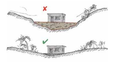
Debe mantenerse una distancia segura respecto de los muros de retención, pendiente arriba y pendiente abajo.
