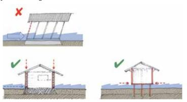
En los muros usar materiales resistentes al agua, o agregar revestimientos de protección para resistir el anegamiento y mantener la solidez durante fuertes lluvias e inundaciones. En este caso, considerar el riesgo de daños a largo plazo a las paredes de tierra que no podrían «respirar». Si se aplica un revestimiento de mortero con arena fina o gruesa en un muro se crea una barrera a prueba de agua.
