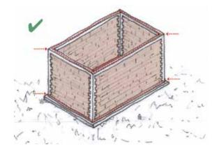
La construcción debe tener una viga reforzada en los zócalos para asegurar una conexión adecuada entre los cimientos y los muros de albañilería.
