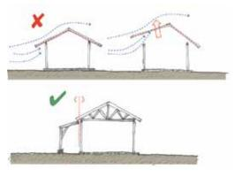
Los aleros del techo deben ser mínimos para evitar que los vientos fuertes lo levanten. La máxima dimensión recomendada es de entre 20 y 30 centímetros.
