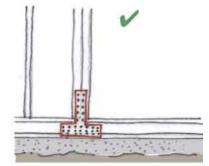
Una banda en forma de T fijada con clavos conecta la madera vertical al suelo.
