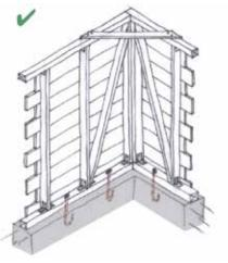
Todos los elementos estructurales deben estar vinculados entre sí por correas de metal anti-huracanes, y la estructura debe arriostrarse para resistir la presión del viento, el agua y las fuerzas originadas por los terremotos. Deben agregarse correas anti-huracanes y arriostramiento en las esquinas para asegurar las fijaciones en las placas superiores e inferiores y en las esquinas de la estructura.
