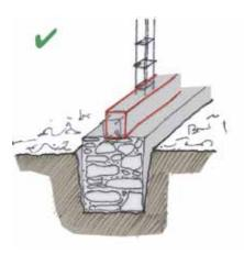
La viga perimetral, alrededor de todo el perímetro de las paredes, conecta éstas entre sí para que la estructura absorba las fuerzas externas en forma integral.
