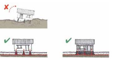
Proporcionar buen drenaje al alojamiento y al asentamiento para minimizar la erosión de los cimientos. Proteger la base de los muros de la erosión pluvial con canaletas, cañerías de evacuación y drenaje. Los sistemas de drenaje mal mantenidos provocan la saturación del suelo y generan inestabilidad.
