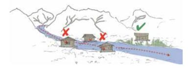
Los alojamientos y asentamientos deben estar sobre suelo estable para evitar el riesgo de colapso o derrumbes durante las inundaciones.
