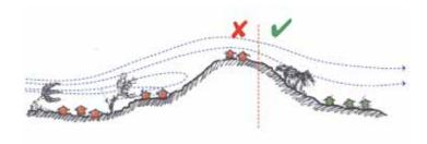
Las construcciones deben estar protegidas de los vientos fuertes por cortavientos. También pueden estar protegidas de las fuerzas del viento por barreras de vegetación.
