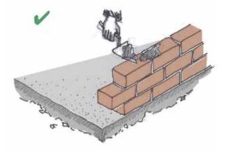
Hacer muros de albañilería con grosor suficiente y mortero fuerte. Las hiladas de albañilería (filas de ladrillos) deben estar bien trabadas (superpuestos) para evitar grietas verticales, y las uniones de los muros deben estar bien ligadas con juntas de mortero de 10 milímetros para mantenerse unidas. La misma recomendación se aplica para albañilería confinada con columnas de concreto utilizando los muros como molde, como se ilustra a continuación.
